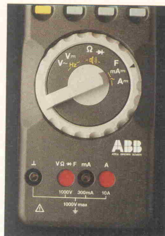
Bild 3. Eine nachahmenswerte Idee: Eine Mechanik gibt nur die Eingangsbuchsen frei, die zum vorgewählten Meßbereich gehören.
