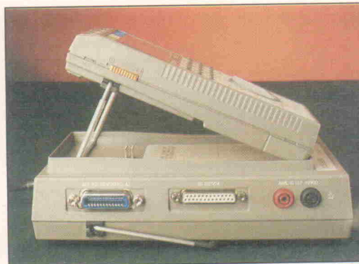
Bild 7. Das MAVO 10-40 ist nicht nur Interface zum MAVO 30, sondern gleichzeitig auch Drucker-Puffer und Schnittstellenumschalter zwischen IEEE-488 und RS-232.
